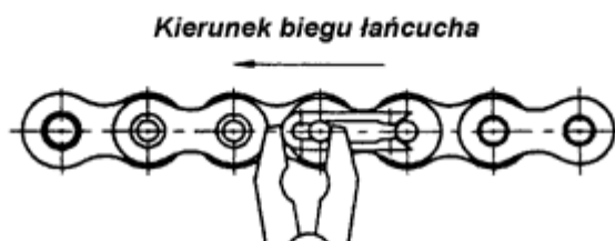
Kierunek montowania zatrzasku
